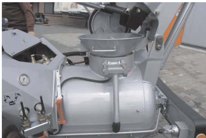
Der Estrich Boy bietet jede Menge Wahlmöglichkeiten bei der Ausstattung: Sicherheitsdeckel, Kesselabgang, Steuerung, Beleuchtung.
