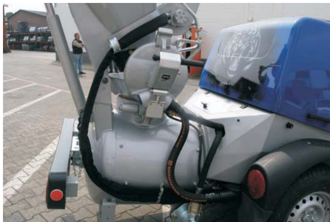
Der Oberluftschlauch wird vom Luftverteiler zum Kessel und der Unterluftschlauch zum Kesselabgang geführt, um das Material in Pfropfen zu zerteilen.
