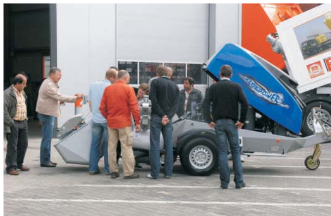
Der Estrich Boy DC 450 Bluepower basiert auf der Grundlage des Estrich Boy DC 450 mit einem umweltfreundlichen 3-Zylinder-Dieselmotor und kann dank der Blue Power Funktion bei Bedarf zusätzliche Leistung zur Verfügung stellen.
