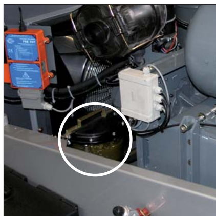
Электрический привод, левая сторона машины, спереди
